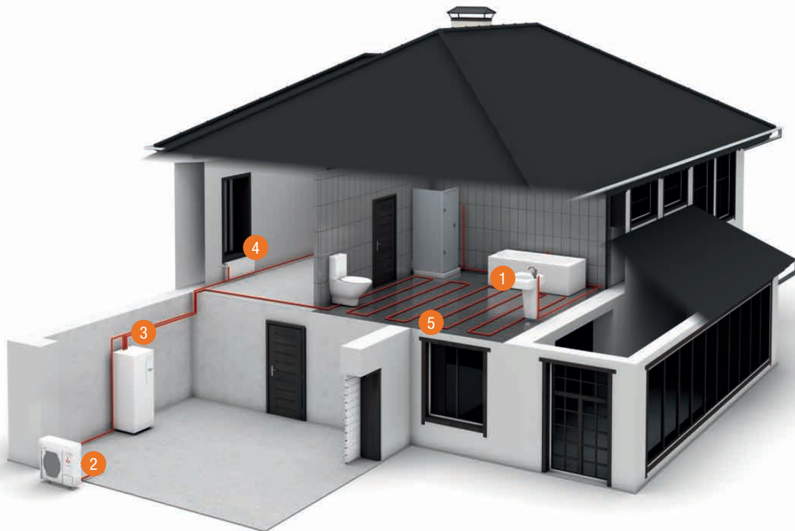
1 Teplá pitná voda, 2 Venkovní jednotka tepelného čerpadla, 3 Vnitřní jednotka Ecodan se zásobníkem teplé vody, 4 Otopné těleso, 5 Podlahové vytápění
